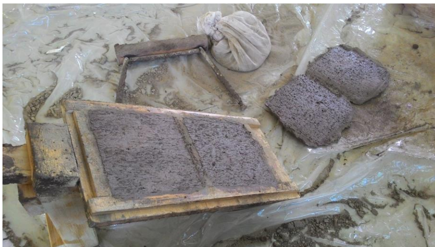
ภาพประกอบ 26: นำดินที่นวดแล้วมาบีบให้ติดพิมพ์แล้วใช้สวดตัดส่วนที่เกินมาออกเพื่อปรับหน้าดิน
