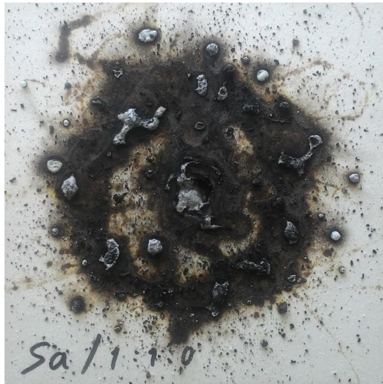
ภาพประกอบ 21: ภาพนิ่งร่องรอยการเผาไหม้ที่เกิดขึ้นจากส่วนผสม
