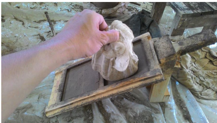
ภาพประกอบ 25: นำซี้ไถ้โรยแม่พิมพ์ก่อนการขึ้นดินเพื่อป้องกันการติดพิมพ์
