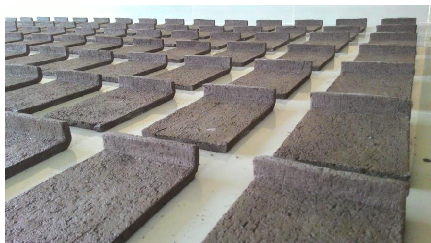
ภาพประกอบ 30: การขึ้นรูปกระเบื้องดินเผาungหลังคา
