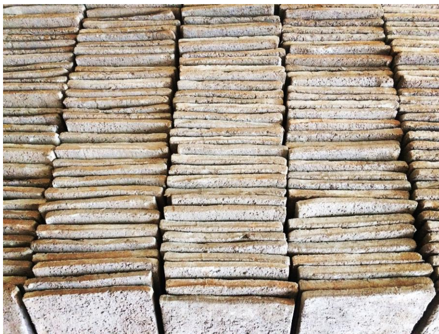
ภาพประกอบ 32: กระเบื้องแห้งสนิทที่พร้อมทำการเผา 1
